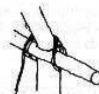
atando los travesaños a las vigas visto de dentro
