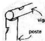
atando una viga al poste de apoyo
