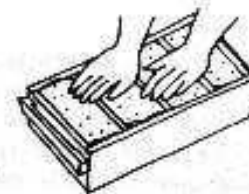
compactar la mezcla
