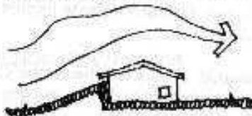
barreras de tierra
